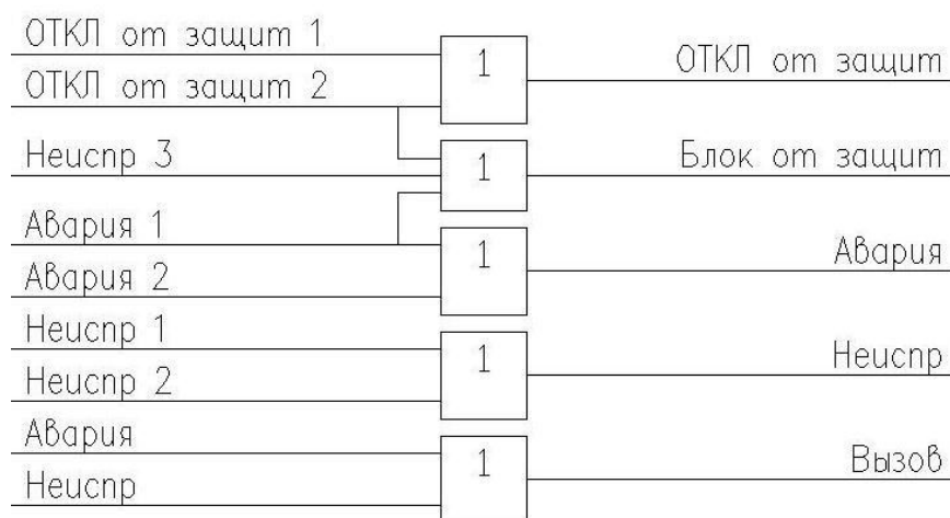
Рисунок 3.14 – Функциональная схема формирования сигналов управления выходными и сигнальными реле
